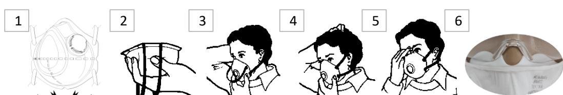
1. Maskeyi paketinden çıktıktan sonra Şekil 1 de gösterildiği gibi 3 boyutlu hale getiriniz.
